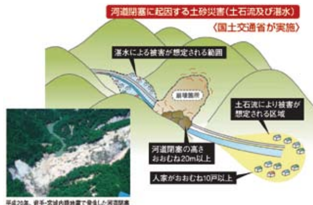
図-2 天然ダムによる緊急調査のイメージ 2)
