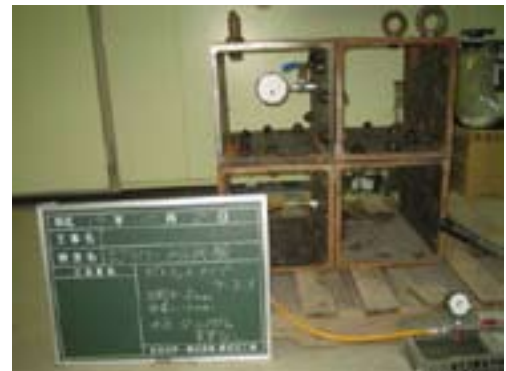
写真-4 いも継ぎの十字部を模擬した止水試験装置
