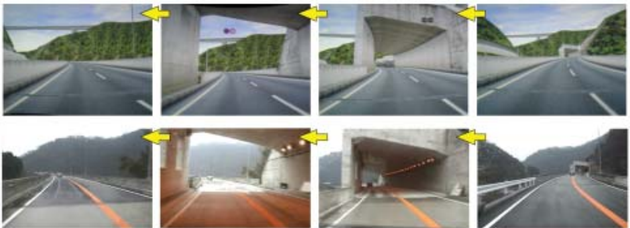
ドライビングシミュレータ(CG)と実道の走行条件比較(上: CG、下: 実道)
