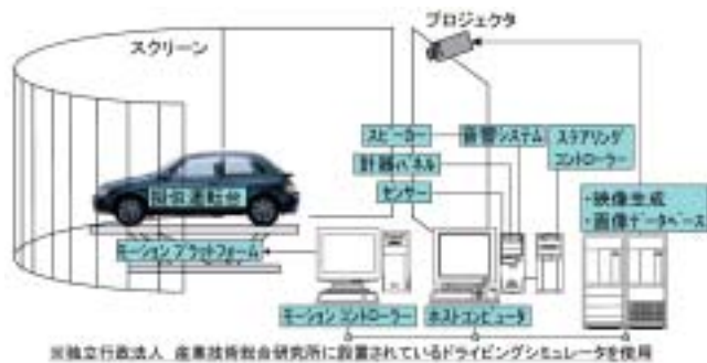
図-4 ドライビングシミュレータシステム構成図
