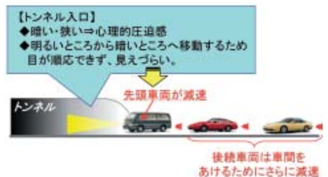
図-2 トンネル入口の減速メカニズム
