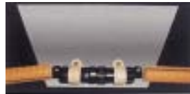
写真-7 転倒センサユニット敷設状況(試作品)
