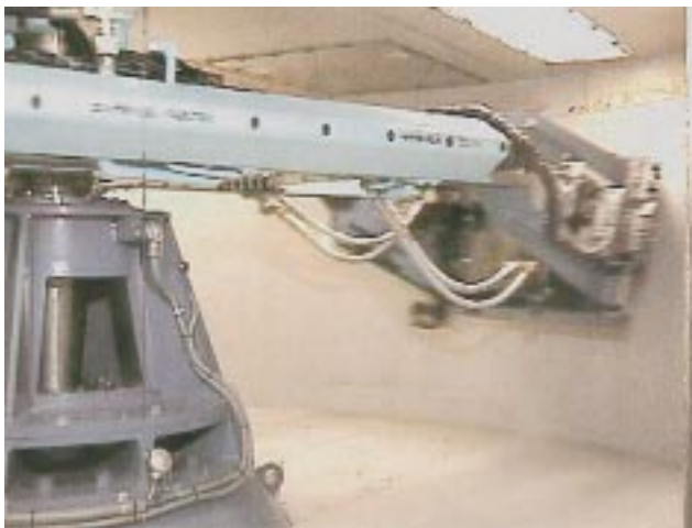
写真 - 2 回転中の遠心装置本体(遠心加速度: 30g)
