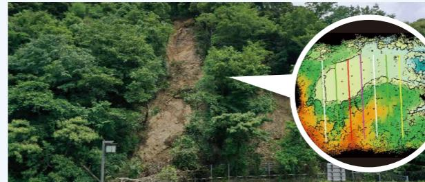
災害箇所のUAV・TLSでの地形図作成
