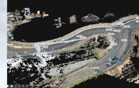
モバイル計測ツールを活用した道路台帳平面図作成
