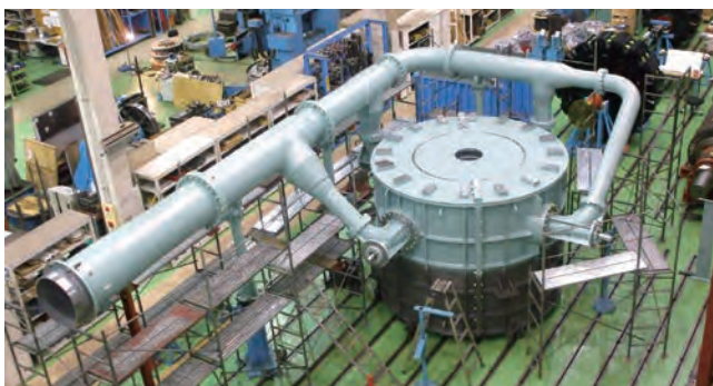
工場にて組み立て中の立軸ペルトン水車
