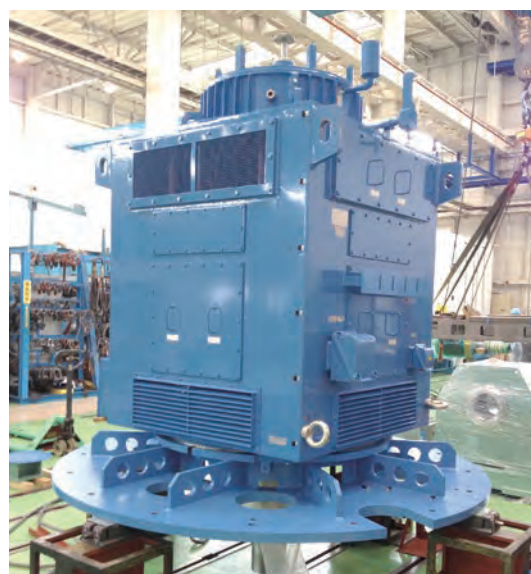
立軸誘導発電機
