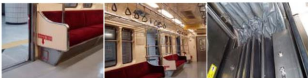
図-1 不燃材が使用されていなかった Degue Metro の車両
