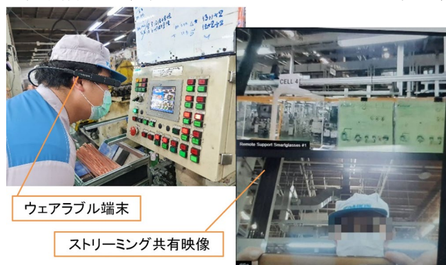
図-14 4K360° カメラによる遠隔作業支援・設備点検
