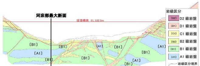
図-16 検討断面位置(ダム軸縦断面岩級区分図)
