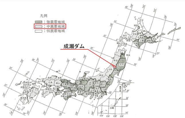
図-11 強震帯、中震帯および弱震帯地域の区分図<sup>1)</sup>
