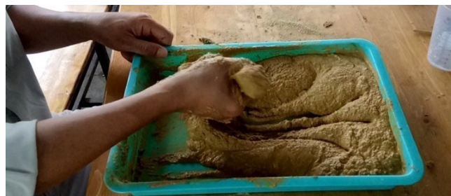
図-20 2 液高粘性可塑状充填材 3)
