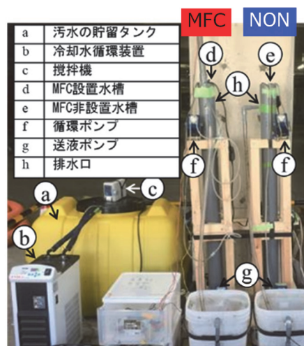
図－9 実験用水槽への MFC の設置状況
