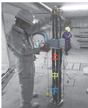
図－5 下水処理場に設置した MFC
