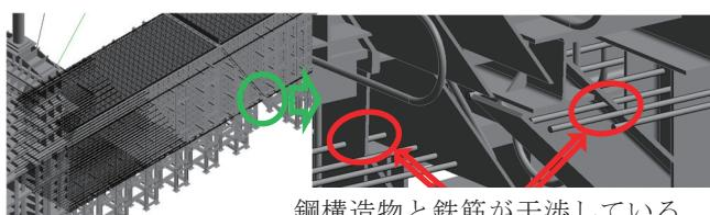
図－14 配筋モデル・配筋干渉モデルイメージ
