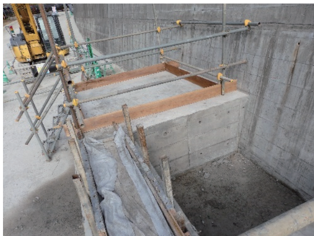
写真-7 実寸大の模擬供試体試験
