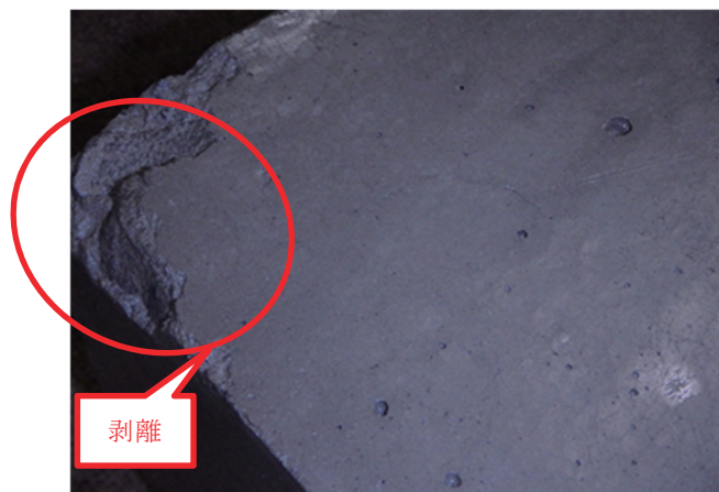
写真-6 無拘束の供試体の剥離
