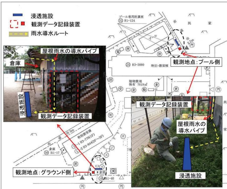
雨水浸透施設設置場所と観測計器外観
