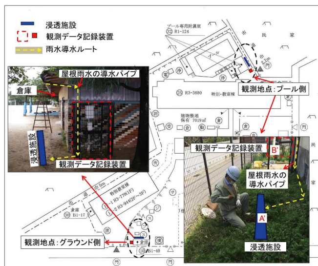
図-1 雨水浸透施設設置場所および観測機器
