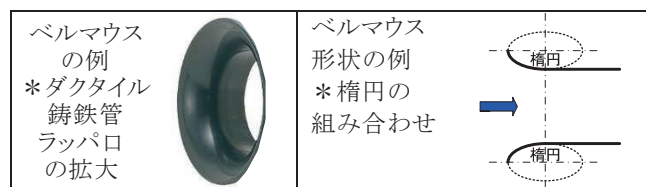
図-10 ベルマウスのイメージ
