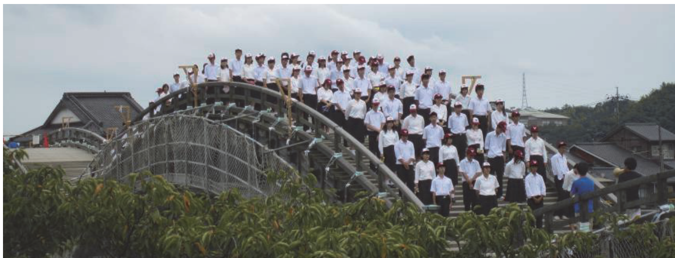
写真－4 地元高校生に荷重となってもら定期調査の様子
