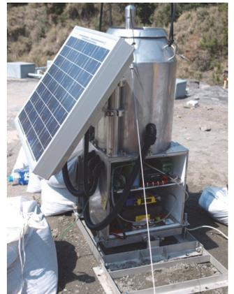
図-2 バケット式自動降灰・降雨量計<sup>4), 6)</sup>
