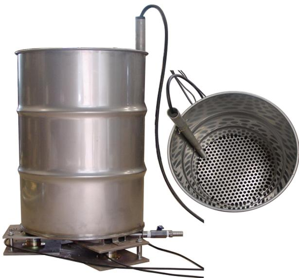
図-1 ドラム缶式自動降灰量計<sup>2)</sup>
