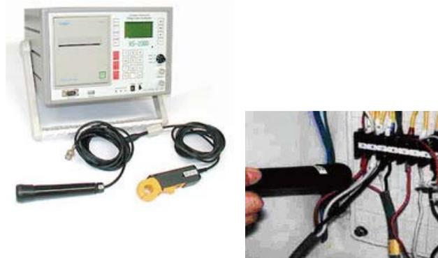
写真－4 高調波診断 診断器例と診断状況<sup>10)</sup>
