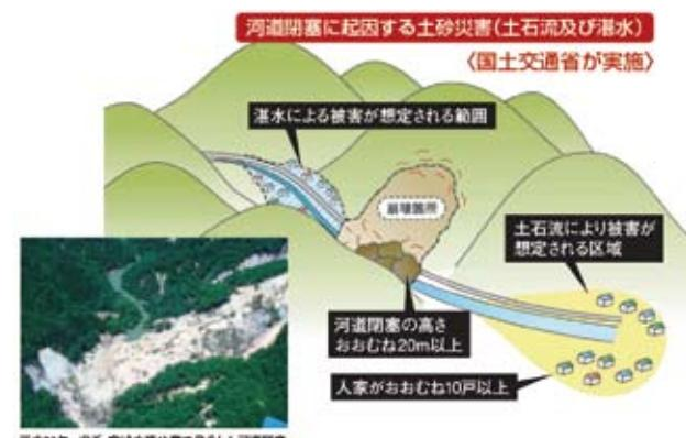
図-2 天然ダムによる緊急調査のイメージ<sup>2)</sup>
