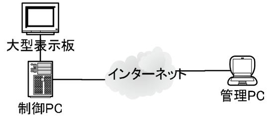
図-4 大型表示装置システムの構成
