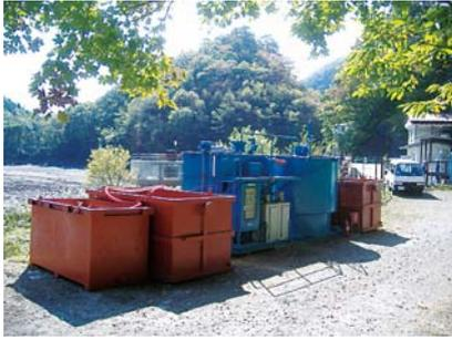
写真-6 濁水処理設備
