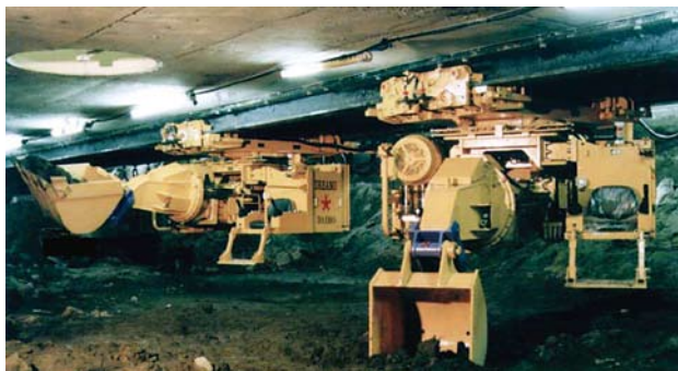
写真－１ 遠隔操作型掘削機 （引用：技術マニュアル、図 2-6、p. 10）
