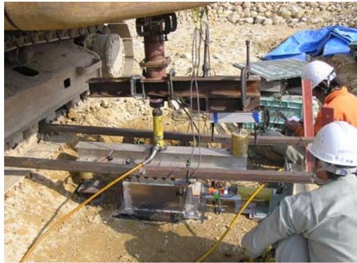
写真－2 現場一面せん断試験状況
