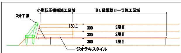
図-18 試験ヤード断面図
