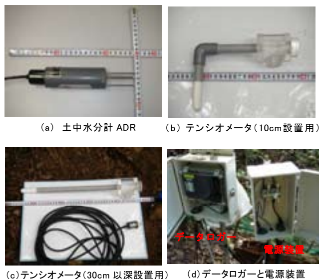
写真－2 設置した計測器(一部)の写真
