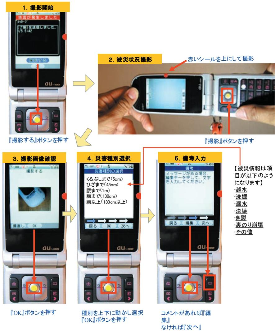
図-6 GPS・カメラ付携帯通報システム
