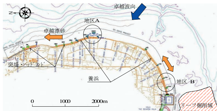
図-3 計画平面図（Sanur 海岸）
