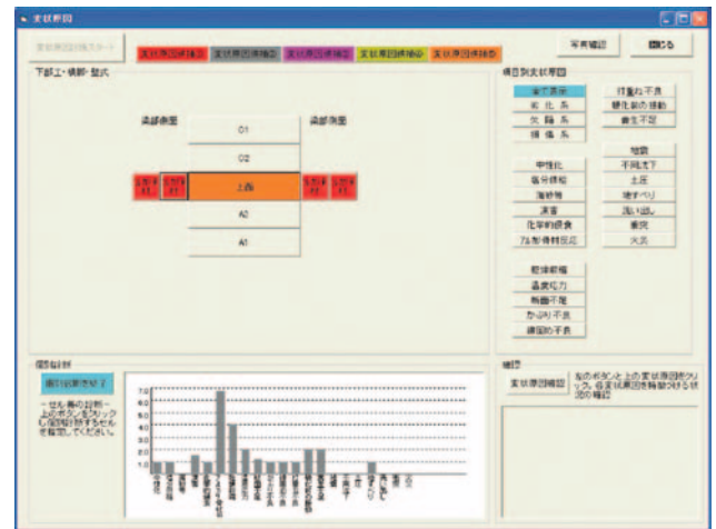
図-10 劣化原因推定結果(橋脚)
