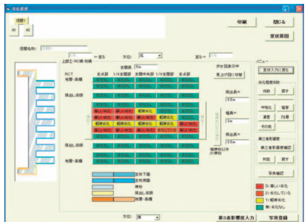
図-9 劣化程度判定結果 (上部工)
