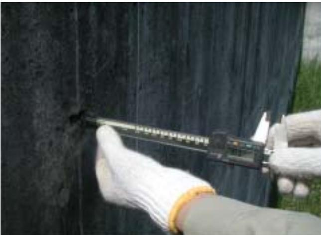
写真-5 ノギスによる中性化測定
