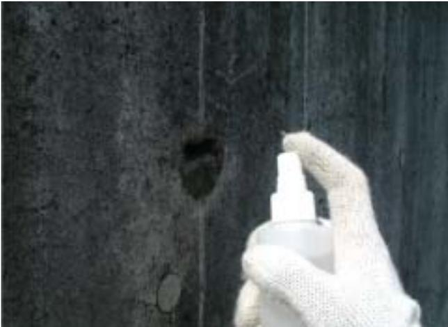
写真-4 孔壁へのフェノールフタレイン溶液噴霧
