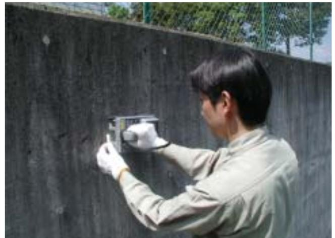
写真-2 レーダによる鉄筋探査
