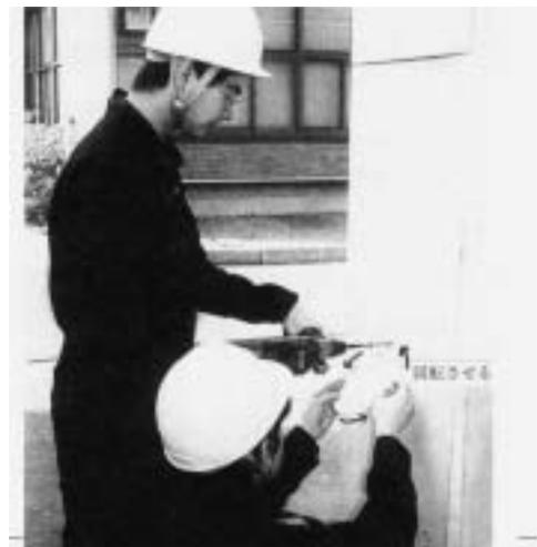
写真-6 試験員2名による中性化深さ測定<sup>5)</sup>
