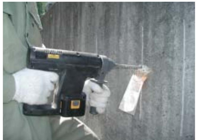
写真-3 ドリル削孔および削孔粉採取
