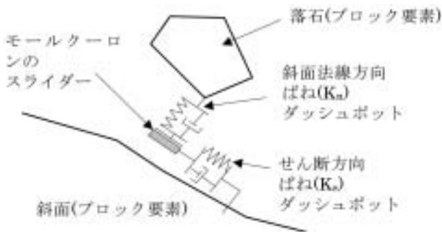
図-7 2次元DEMモデル(落石と斜面の接触)
