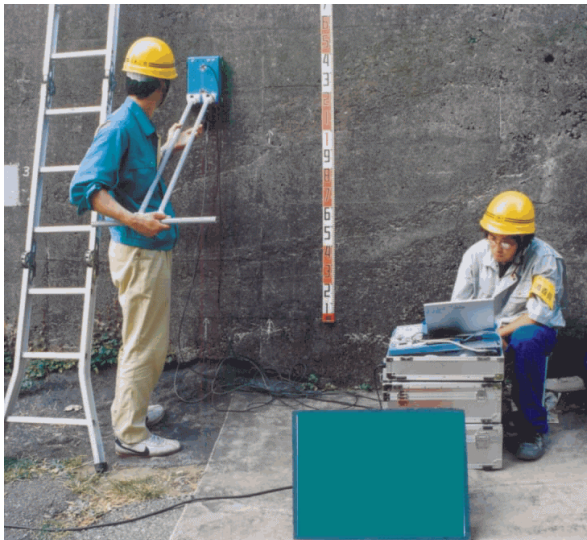
写真-2 レーダ計測状況(鉄筋探索)
