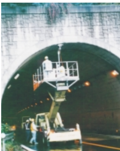
写真 - 8 レーダによる道路トンネル覆工厚・空洞高計測状況
