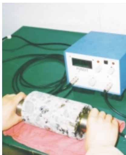
写真 - 13 コンクリートの超音波伝播速度計測状況
