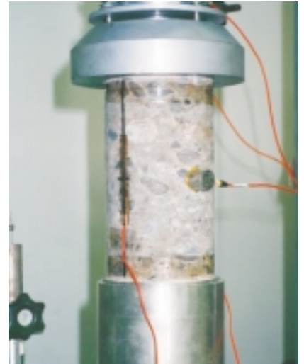
写真 - 4 AE法による劣化コンクリートの品質評価
