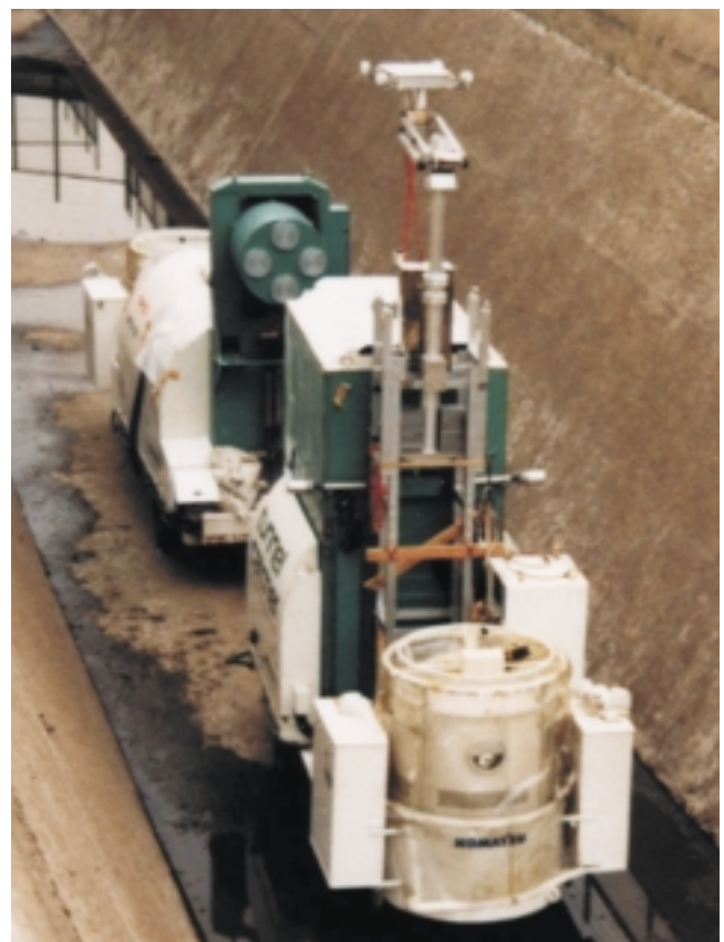
写真-1 小断面トンネル用レーザ・レーダ計測システム
