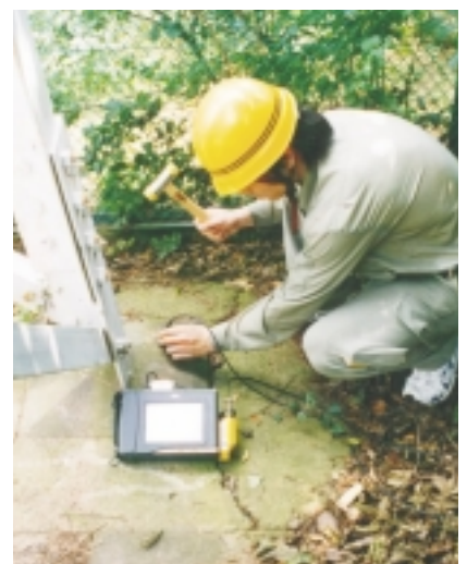
写真 - 10 衝撃反射法による鉄塔基礎深さの計測状況
