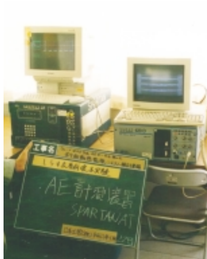
写真 - 3 しらす崩壊実験に使用中のAE計測装置
