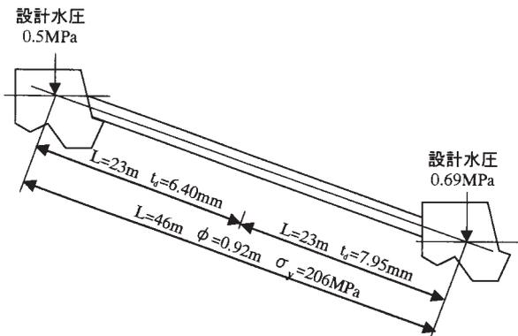
図-7 実水圧鉄管の解析条件
