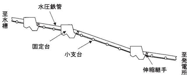
図-1 水圧鉄管の例
