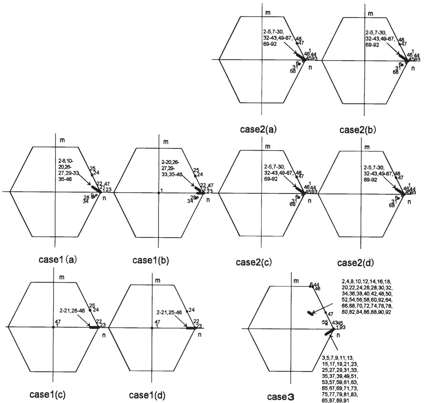
図 - 10 塑性崩壊時における各節点の内力
