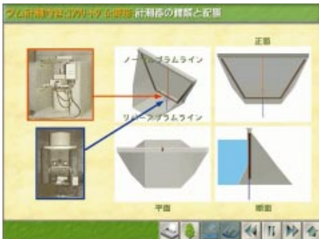
図 - 8 コンクリートダムの変形測定器の配置
