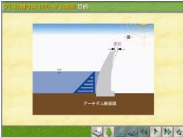
図 - 7 コンクリートダムの変位計測の目的
