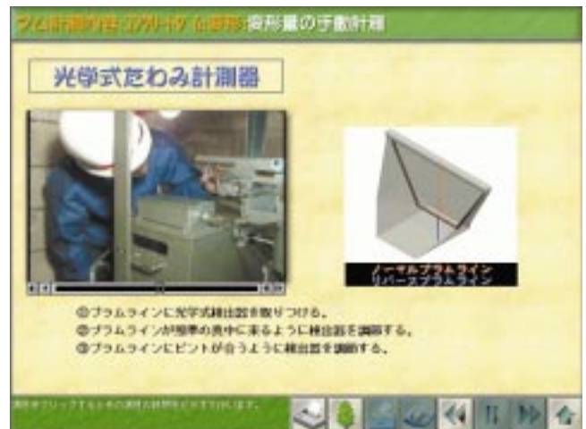
図 - 10 コンクリートダムの層別沈下量測定方法
