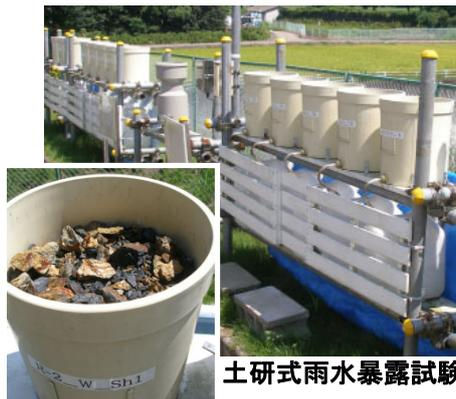
土研式雨水暴露試験
