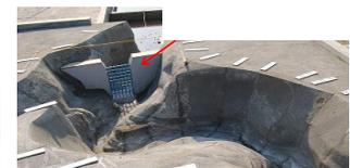
図-6 砂防堰堤の機能を説明するツール作成のための実験例(左:透過型堰堤, 右:格子型ハイダム)
