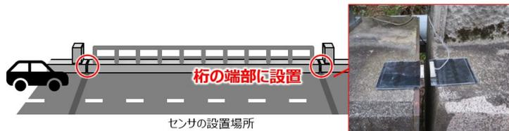
桁端部異常検知の原理
