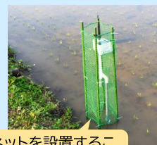
写真3. 音波式水位計による水位観測
