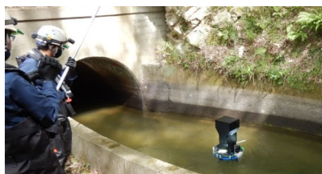
これまで人力で実施していた水路トンネルの壁面や背面の変状を確認する調査を、通水時に使用できるフロート式ロボットで代替できるか、実証実験を行いました。船体自立制御によりトンネルの中心を走行する、とても賢く便利なロボットです。
