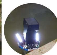
これまで人力で実施していた水路トンネルの壁面や背面の変状を確認する調査を、通水時に使用できるフロート式ロボットで代替できるか、実証実験を行いました。船体自立制御によりトンネルの中心を走行する、とても賢く便利なロボットです。
