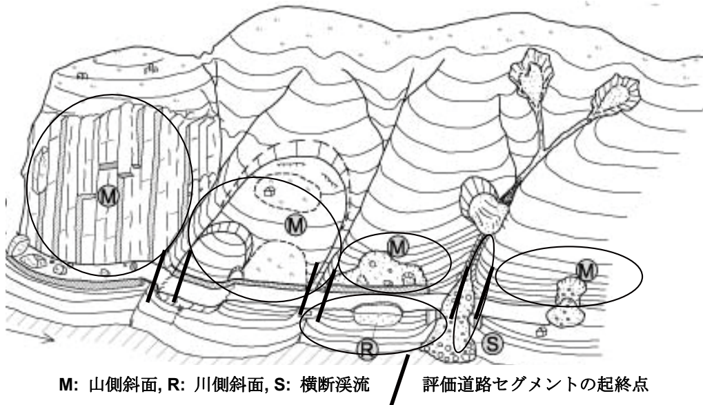
図-2 道路斜面点検・評価と最終評価道路セグメントの範囲
