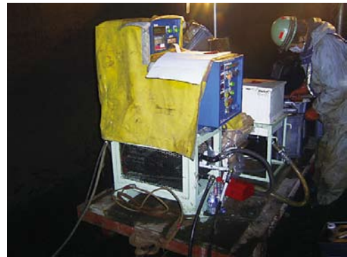
写真-13 発泡ウレタン注入機
