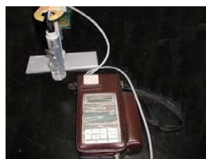
写真-1 簡易塩分測定状況
