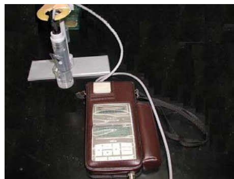
写真-2 簡易塩分測定状況
