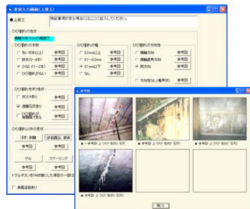
図-2 劣化診断ソフトの変状入力画面
