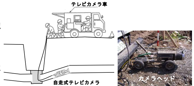
図-1 テレビカメラによる管内調査
