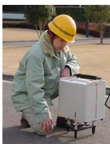
重力探査状況
